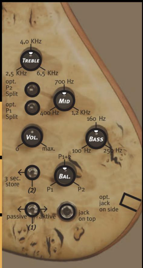
Sind die gewünschten Eckfrequenzen eingestellt, werden diese durch drei Sekunden langes Halten des Speicher-Tasters (**2**) abgespeichert. In der Aktiv-Stellung des Schalters (**1**) können nun die abgespeicherten Frequenzen über die Tonregler (+/- 14dB) angehoben oder abgesenkt werden.
